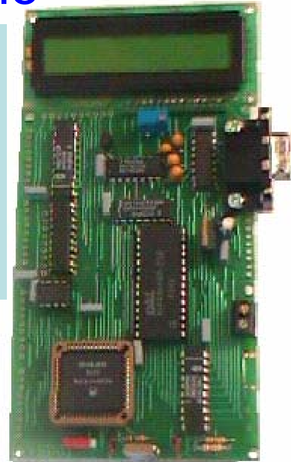
Carte d'application 68HC11 pour Travaux Pratiques, conçue et fabriquée en 12 exemplaires pour IUT et Faculté de physiques de Douala
